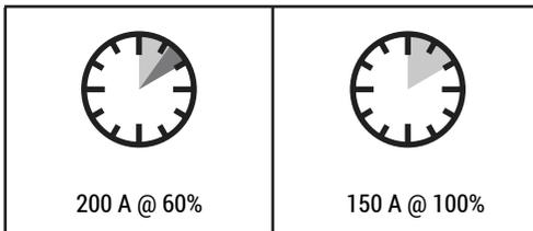
A ilustração acima reflete exatamente o ciclo de trabalho de seu equipamento FLAMA 201 BV. 60% = Dentro de um período de 10 minutos você pode soldar por **6,0 min**, e é obrigado a deixar o equipamento ligado porém sem arco aberto (solda) por **4,0 min**. Lembrando que essa regra vale apenas se a Amperagem estiver no máximo. 100% = Agora se a amperagem da máquina estiver em **150 A** ou menos, você pode soldar sem limitação, ou seja, sem precisar descansar.
