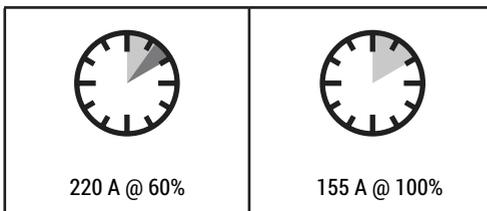
A ilustração acima reflete exatamente o ciclo de trabalho de seu equipamento FLAMA 221. 60% = Dentro de um período de 10 minutos você pode soldar por **6,0 min**, e é obrigado a deixar o equipamento ligado porém sem arco aberto (solda) por **4,0 min**. Lembrando que essa regra vale apenas se a Amperagem estiver no máximo. 100% = Agora se a amperagem da máquina estiver em **150 A** ou menos, você pode soldar sem limitação, ou seja, sem precisar descansar.
