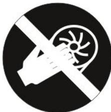
(b) Nunca utilize o soprador sem que a tela de entrada de ar esteja bem instalada. Antes de usar, verifique se o parafuso de fechamento está bem apertado e se não está danificado.
